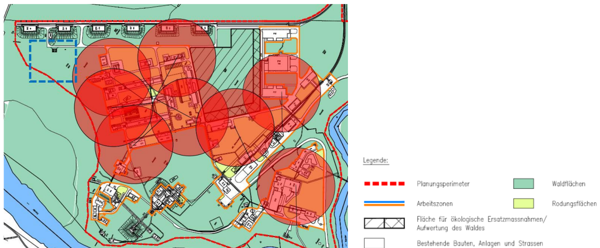
Abb. 4 Erforderlichen Abstandsradien von 86 m (rote Kreise) auf bestehenden Produktionsgebäuden
