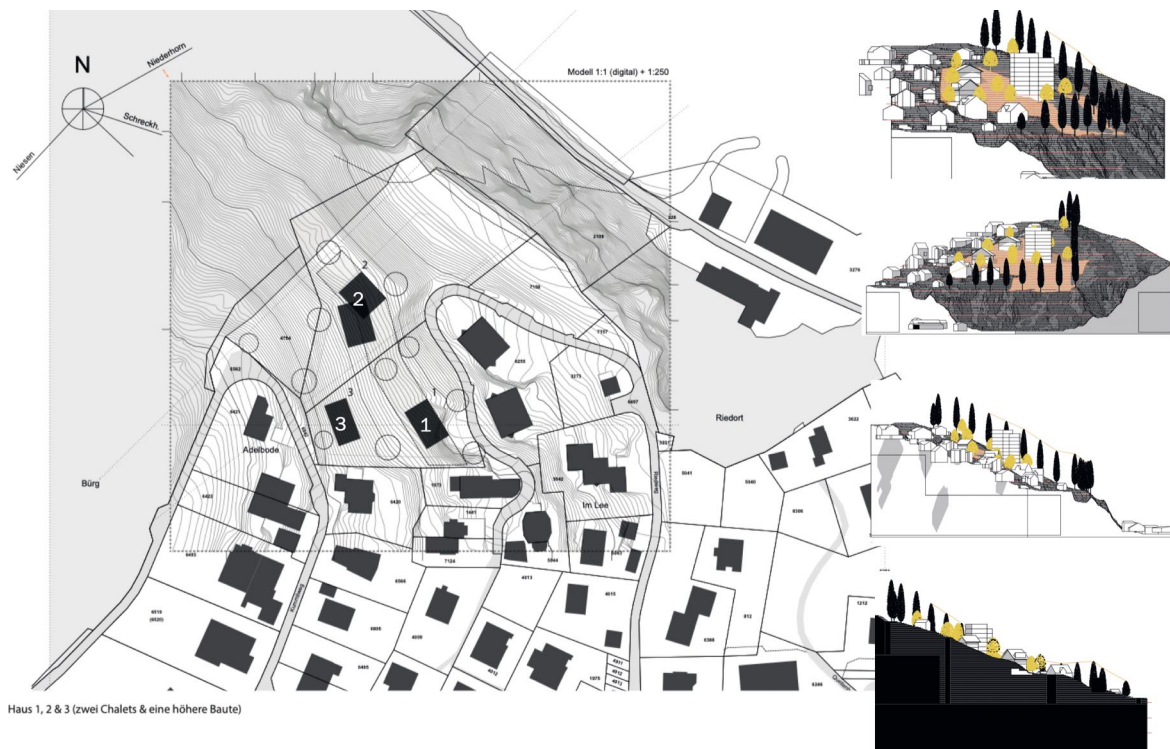
Abb. 6 Situation, Lage der Gebäude; rechts von oben nach unten: Ansicht Ost, Ansicht See, Ansicht Faulensee, Schnitt Faulensee
