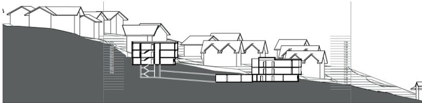
Variante 3 ist eine Untervariante der Variante 2 «Zeilenbauten» und wird ebenso charakterisiert durch die Konzentration der Nutzungsdichte in zwei langgezogenen, zweigeschossigen Baukörpern, die Einbettung in den Hangverlauf und den Durchfluss des grosszügigen Landschaftsraum durch den zusammenhängenden Aussenraum. Auch hier ist bei sämtlichen Wohnungen eine gute Aussichtslage garantiert und alle Wohneinheiten lassen ein durchgehendes Wohnen (Ost/West) zu.
