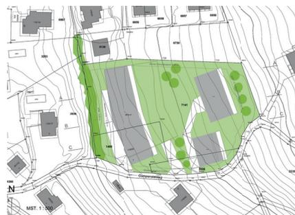
Die knappen Gebäudeabstände, gepaart mit den erhöhten Grenzabständen zur bestehenden Hecke im Westen und den Obstbäumen im Osten führt zu einer Konzentration der Bauten im Zentrum des Areal und einer recht dichten Wirkung. Die Aussenräume werden durch die Anordnung der Bauten kleinteilig. Zur Erschliessung der einzelnen Bauten sind verschiedene Zugänge notwendig, unter anderen ein unschöner Hangeinschnitt für die Zufahrt zur Einstellhalle. Die Fernsicht der Wohnungen ist teilweise eingeschränkt.
