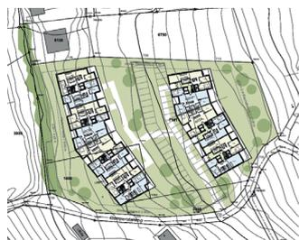
Variante 2 «Zeilenbauten» wird charakterisiert durch die Konzentration der zu erreichenden Nutzungsdichte in zwei langgezogenen, zweigeschossigen Baukörpern. Durch die Abwinkelung schmiegen sich die beiden Formen optimal in den Hangverlauf. Der Landschaftsraum fliesst durch den grosszügigen, zusammenhängenden Aussenraum, der durch die beiden Gebäude aufgespannt wird, in das Areal. Bei sämtlichen
