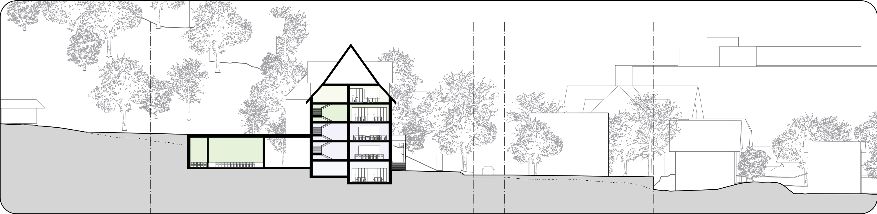
Schnitt Bestandesgebäude - Neubau Nord
