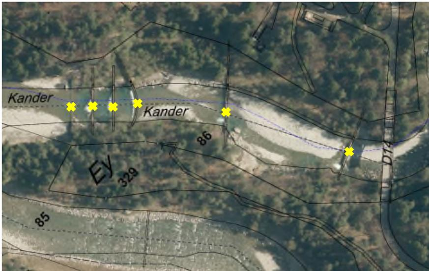
Abbildung 21: Abzubrechende Betonschwellen (gelb).
